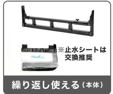
とめっばは、玄関に“つっぱりだけ”で、手軽に浸水対策ができる簡易型止水シートです。専用の止水シートとつっぱり機構で、縦にも横にもピタッと密着。工具は不要で、一人でも約5分で設置可能。とめっば本体は繰り返し使用ができます。対応開口寸法は85～125cmです。シンプルですがタフ設計なので、浸水高さ50cm(約100kg相当の水圧)の止水テストでも止水性能を維持します。
