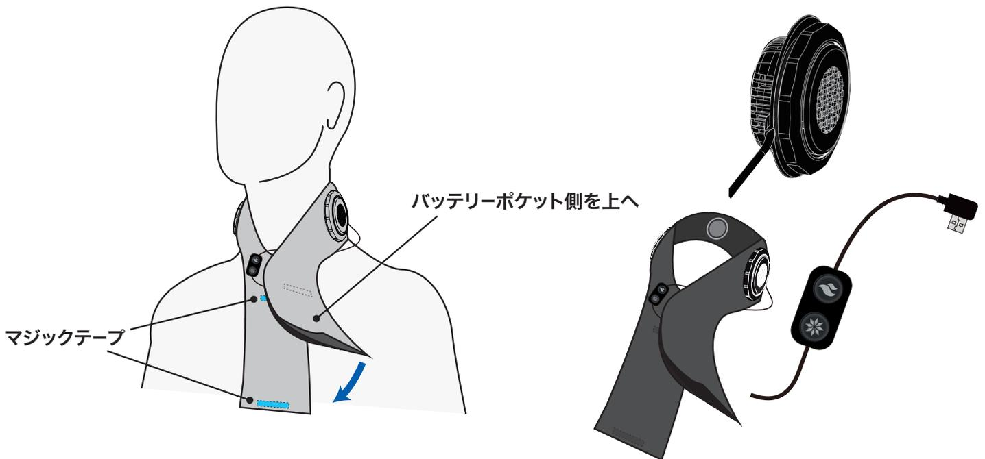
ペルチェ素子を利用したプレートにより、冷却と温熱両方の用途に使用できる、首に装着するデバイスです。冷却機能は環境温度から約 $-22^{\circ}\text{C}$ 、温熱機能は表面温度が約 $42^{\circ}\text{C}$ の温度になります。プレートが体に触れることでダイレクトに冷やす・温めることができます。温度は5段階で調節でき、ゆらぎ機能(10分間稼働、2分間切)があり、温熱時の低温やけど対策、冷却では繰り返し効果が実感できるようになっています。デバイスの装着個数もカスタマイズにより増やすことができます。
