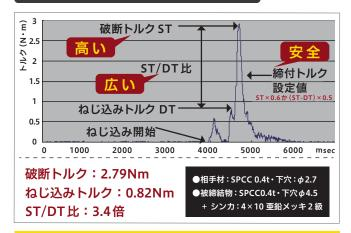
トルク比 (ST/DT) が大きいため、締め過ぎによる空転の リスクが低く、安全に締結が可能。
