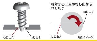
相手材に二つのねじ山が同時に接触。 軸アラインメントが向上し、真っ直ぐに締結できます。
