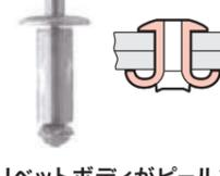
リベットボディがピール状に4方向へ開いて、母材を締結します。樹脂などの軟材質母材の締結に適します。
