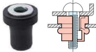
ナットボディ内部に特殊スリーブを装着しているため、ボルト締め時のトルク管理が不要になります。
