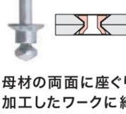
母材の両面に座ぐり加工したワークに締結し、両面ともにほぼフラットに仕上がります。
